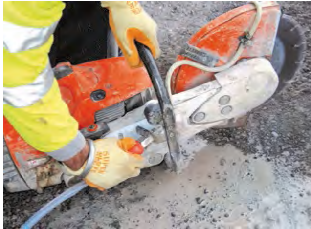
1. ábra: Vízpermetező rendszerrel rendelkező betonvágó Forrás: Health and Safety Executive, Nagy-Britannia (a továbbiakban: HSE)
