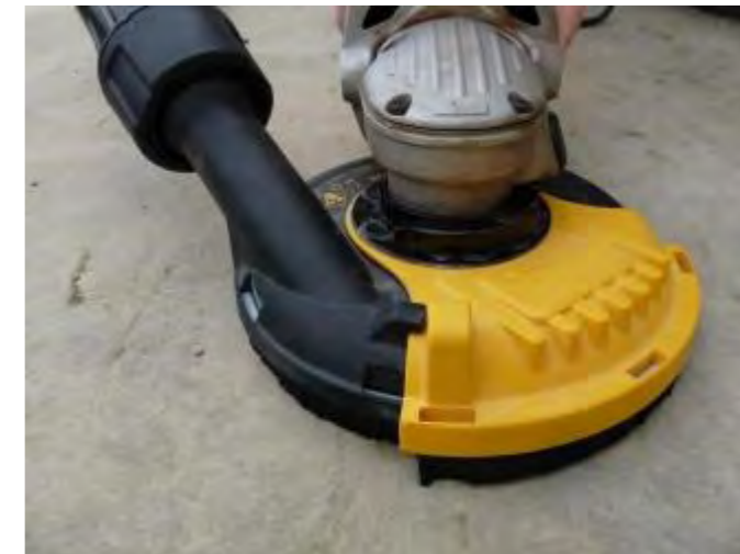
4. ábra: Betoncsiszoló az eszközre szerelt („on-tool”) elszívóval Forrás: HSE
