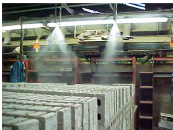
3. ábra: Vízpermetező rendszer alkalmazása téglagyártásnál Forrás: NEPSI ( https://guide.nepsi.eu/ )
