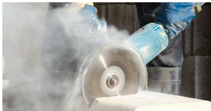
2. ábra: Vízpermetező rendszerrel nem rendelkező betonvágó Forrás: NEPSI ( https://guide.nepsi.eu/ )
