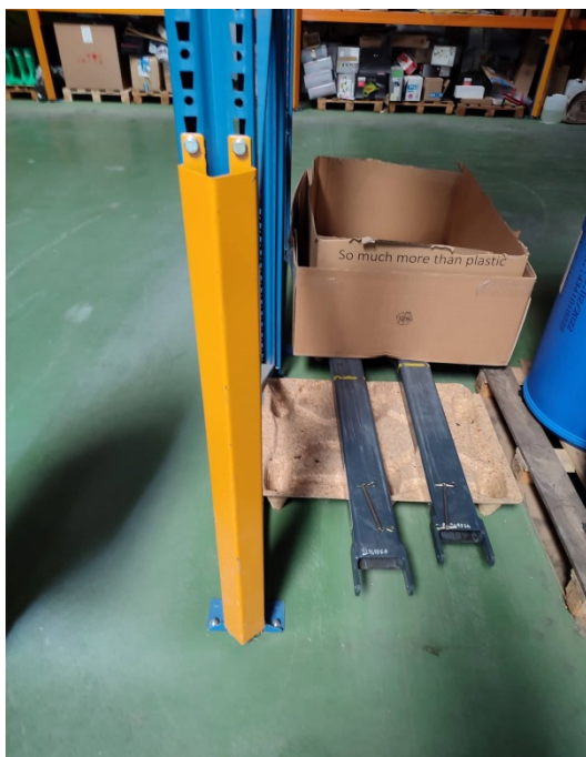
Az állványszerkezethez rögzített ütközést gátló elem
