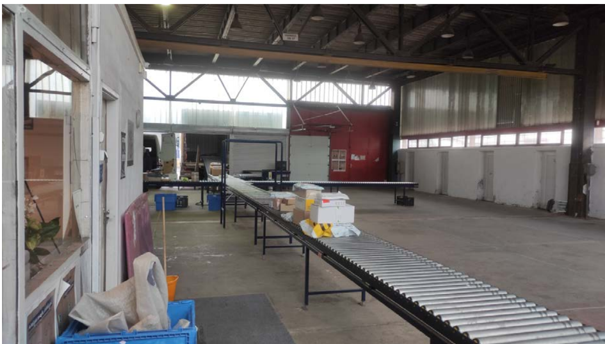
Munkavállalók által végzett kézi anyagmozgatás könnyítése érdekében a munkáltató egy görgős csomagszállító berendezést helyezett üzembe
