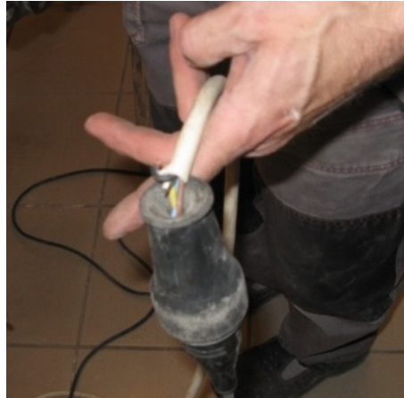
Beschädigtes Verlängerungskabel
