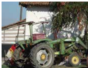
Borulás esetén a vezető számára védelmet nyújtó védőkerettel felszerelt traktor
