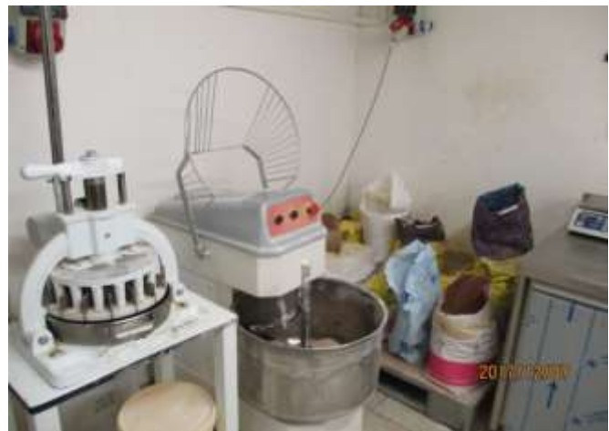
Dagasztógép hiányos védőráccsal.
