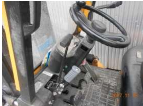
Emelővillás targonca indítókulcs a targoncában, illetve a műszerfalon. (Illetéktelenek által hozzáférhető.)
