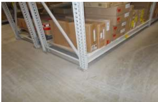
Raktárban a fém állványok sarkainál targoncaütközés elleni állványoszlop védőt nem helyeztek el.
