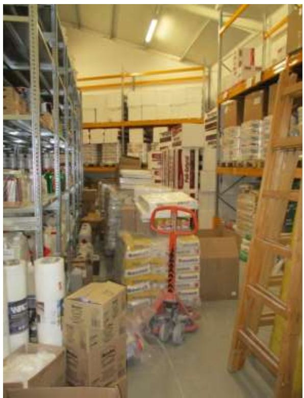
Gépi-, és kézi kiszolgálású állványok előtti szabálytalan tárolás.
