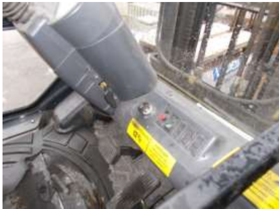
Emelővillás targonca indítókulcs a targoncában, illetve a műszerfalon. (Illetéktelenek által hozzáférhető.)
