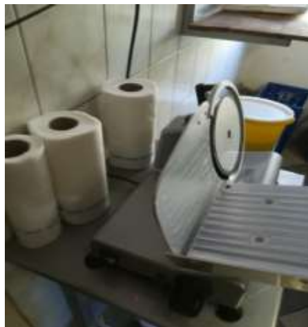
Szeletelő gép leszorító kar hiánya.
