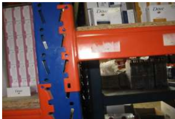
Fémszerkezetű állvány hossztartó akaratlan elmozdulását biztosító rögzítő eleme hiányzott.
