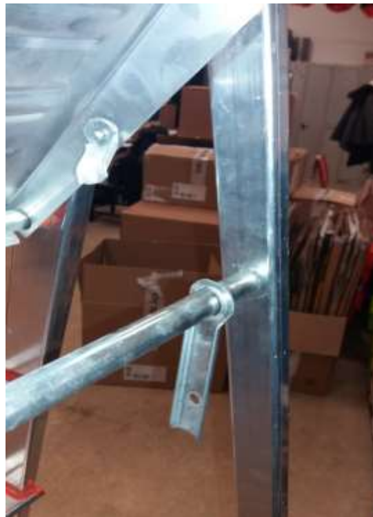
Törött alumínium biztosító-rögzítő szerelékű létra.
