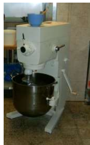
Dagasztógép hiányos védőráccsal.
