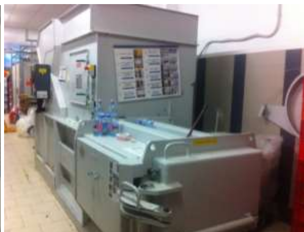
Hulladéktömörítő berendezés. szabályos jelzésekkel, kezelési utasítással.
