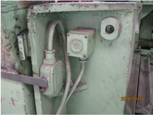
Táblalemez hengerítő gép „terepszínű” vészleállítóval
