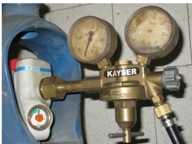
Tengelyéről elvált mutatójú nyomásmérő óra
