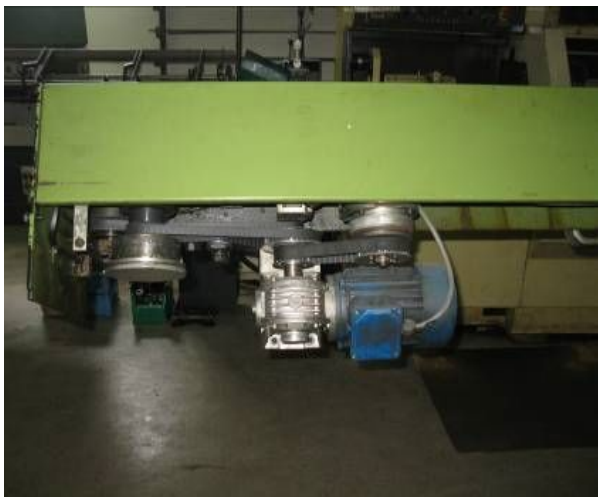
Hosszúanyag adagoló egység ékszíjhajtása burkolat nélkül
