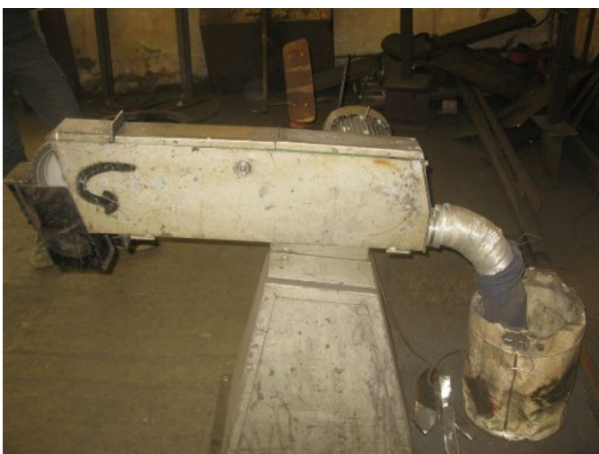
Fémipari szalagszológép elszívó csomját nyitott fém edénybe „csatlakoztatták”.
