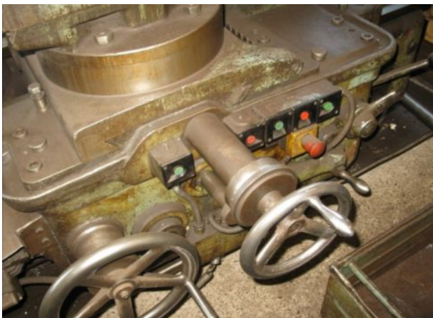
Egyetemes esztorgagépen funkció jelölés nélküli kezelőszervek.
