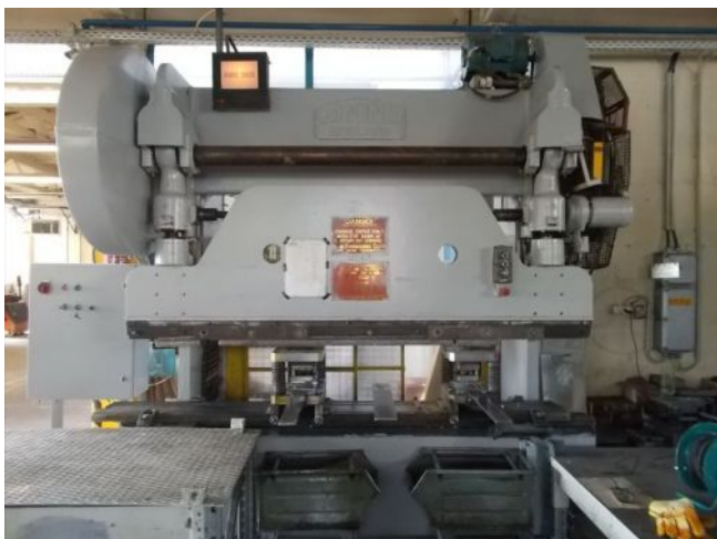
A 60 tonnás excenter sajtológépen kétkézes indítószerkezet kialakítva nem volt, működtetése lábpedál segítségével történhetett, azonban a szerszámok nyitása 4 cm-es volt, így veszélyes térbe a szabadon maradt kezekkel be lehetett nyúlni
