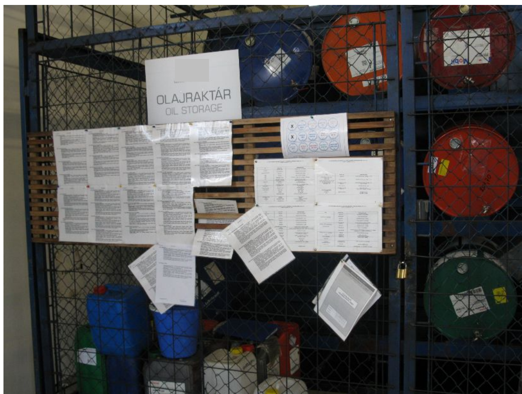
A technológia során használt veszélyes vegyi anyagok, keverékek megfelelő, zárt módon történő tárolása, az állvány alatt rozsdamentes acélból készül kármentő tálcával
