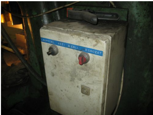
A 80t-ás excenter prés gép üzemmódváltó kapcsolója nem zárható
