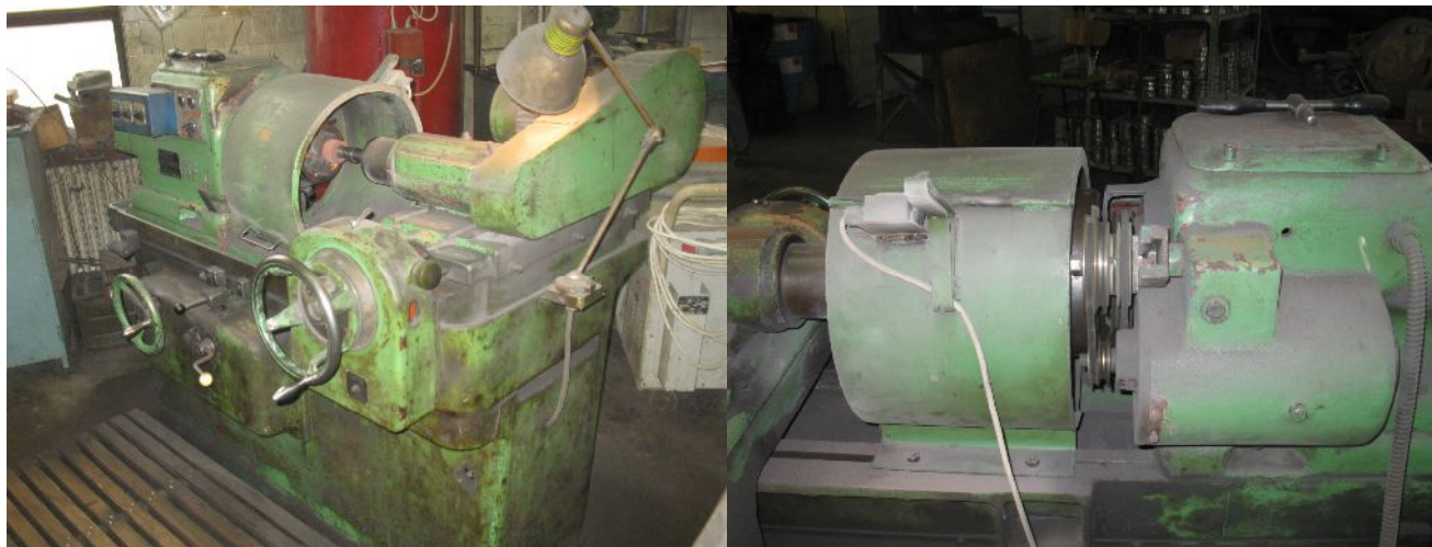
A furatköszörű gép tokmánymeghajtó ékszíjhajtás védőburkolata hiányzott, a veszélyes munkateret nem határolta el a kezelőhelytől
