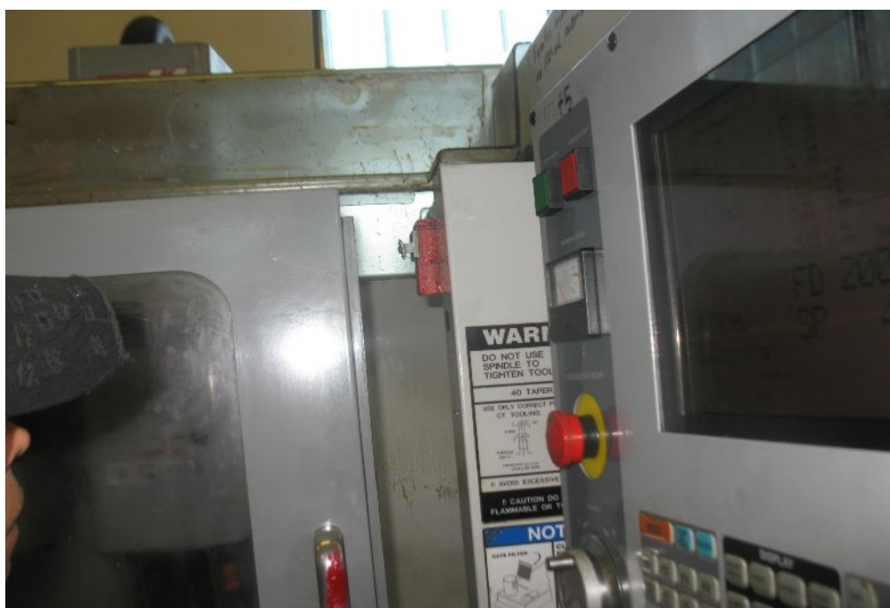
A megmunkáló központ védőburkolatának reteszelését kiiktatták
