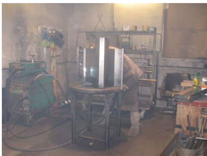
Saválló kazán elem hegesztési munkahely, elégtelen teljesítményű szellőztető berendezés.
