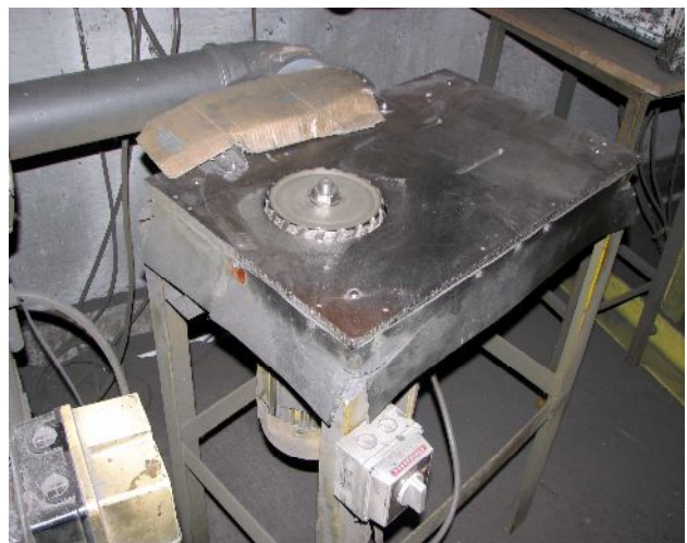
Védőburkolat nélkül, magas fordulaton üzemelő ívelő-csiszológép
