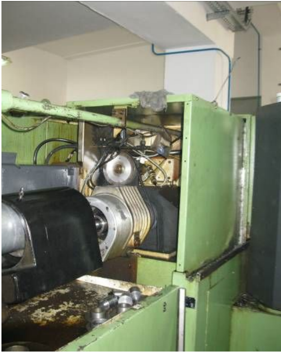
Lemezhengerítő gép henger meghajtásának teljes burkolata hiányzott
