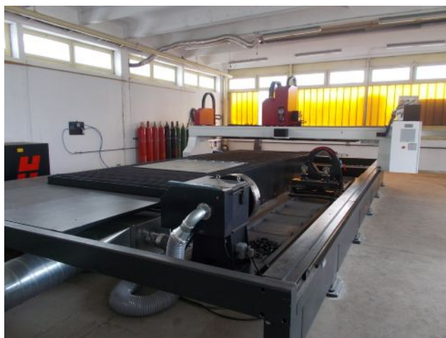
Megfelelő kiszolgáló térrel rendelkező, feliratozással ellátott, a technológiai folyamat során keletkező gázok, gőzök elszívására alkalmas berendezéssel felszerelt plazmavágó gép, optoelektronikai védőberendezéssel lehatárolt veszélyes térrel
