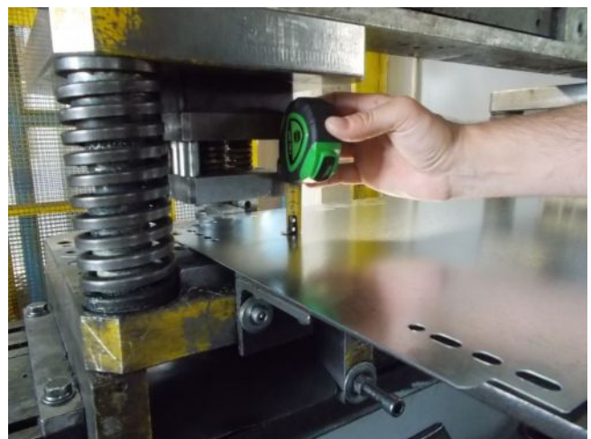
A 60 tonnás excenter sajtológépen kétkézes indítószerkezet kialakítva nem volt, működtetése lábpedál segítségével történhetett, azonban a szerszámok nyitása 4 cm-es volt, így veszélyes térbe a szabadon maradt kezekkel be lehetett nyúlni
