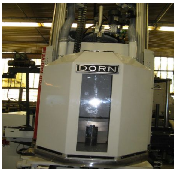
Megfelelően burkolt, automata rugógyártó gép
