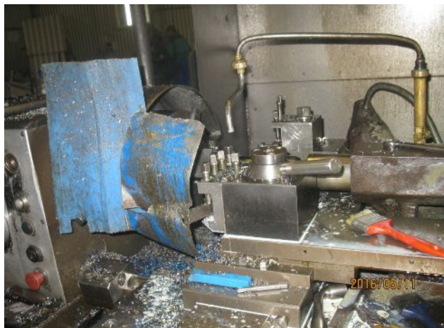
Eszterga gépen házilag készített védőburkolat
