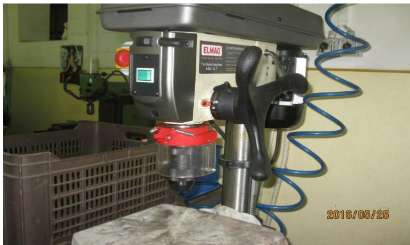
Kézi vezérlésű fúrógép fúróorsójához a hozzáférés védőburkolattal megakadályozott
