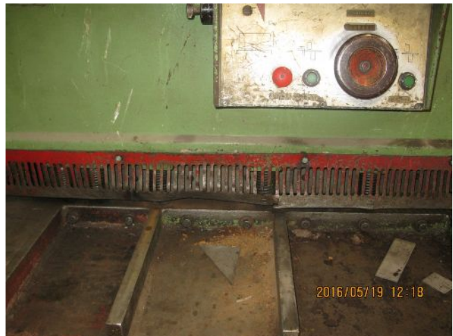
Táblalemez olló gép elhajlott, sérült védőráccsal
