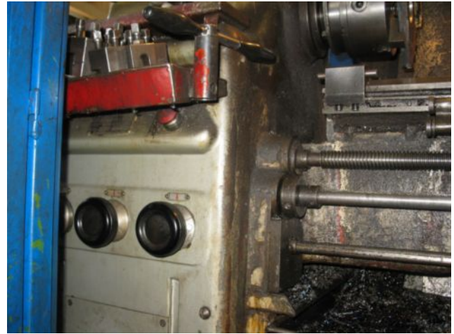
Esztorgagépen a szerszámtartó alatt „eldugott” vészleállító nyomógomb
