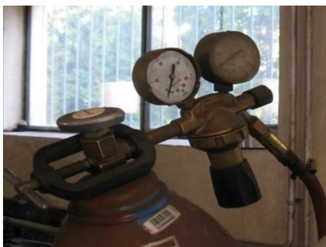
A nyomásmérő üvege hiányzott
