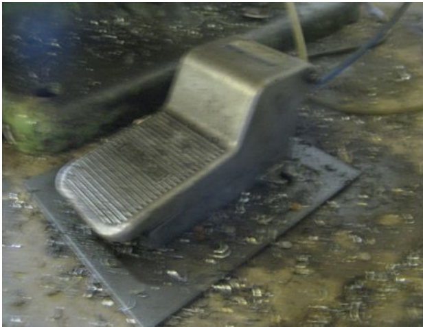
15 tonnás excenter prés lábpedálja nem rendelkezik akaratlan működést kizáró védőburkolattal
