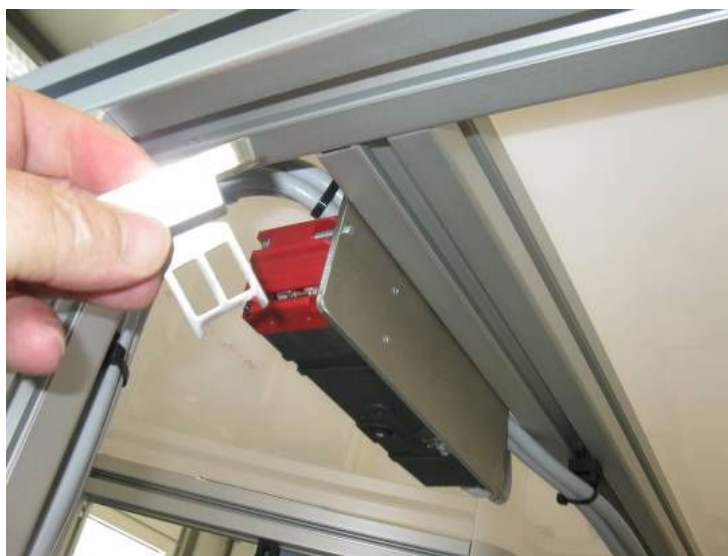
CNC megmunkáló központ kiiktatott reteszelésű nyitható védőburkolata
