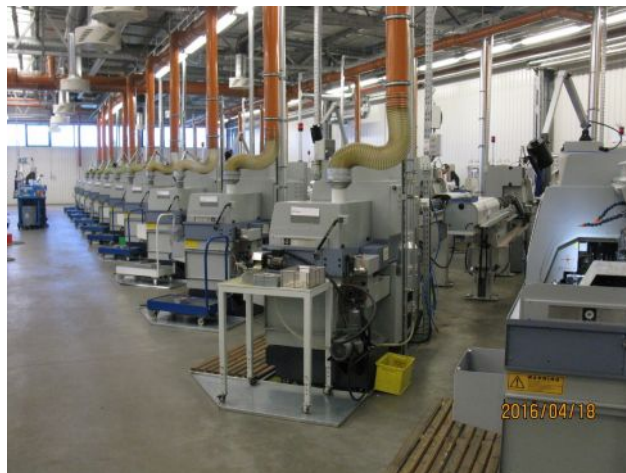
Korszerű CNC eszterga csarnok gépenkénti elszívással
