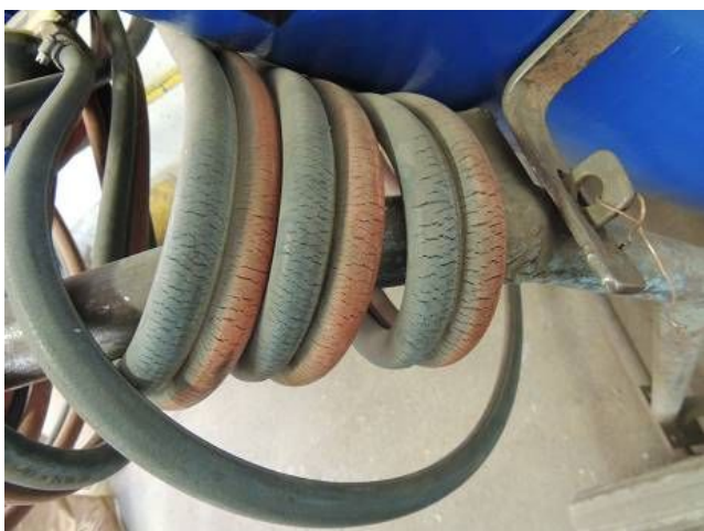
Repedezett, sérült hegesztő tömlők
