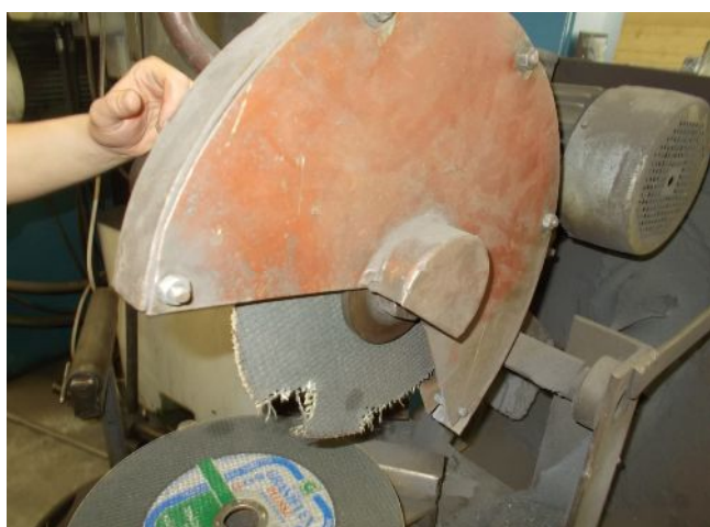
Sérült vágókoronggal felszerelt darabológép
