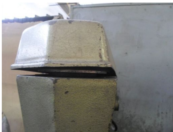
A fűrőgépen az ékszíjtárcsa burkolata nincs rögzítve, a tárcsa elérhető
