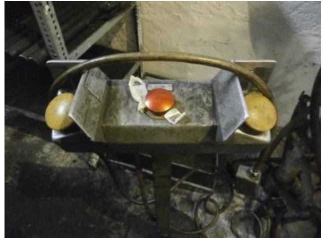
A kétkézes indító berendezés mindkét kezelőgombjáról hiányzott a véletlen nyomódást megakadályozó védőlemez
