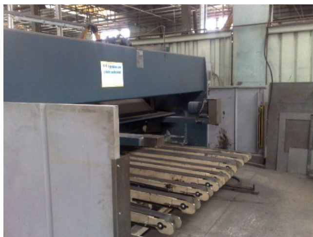
Táblalemezolló veszélyes terének optoelektronikus védőberendezéssel történő elhatárolása
