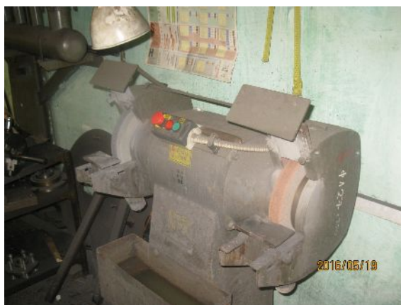
A forgácsoló műhelyben talált köszörűk szemvédő ernyői el voltak koszolódva
