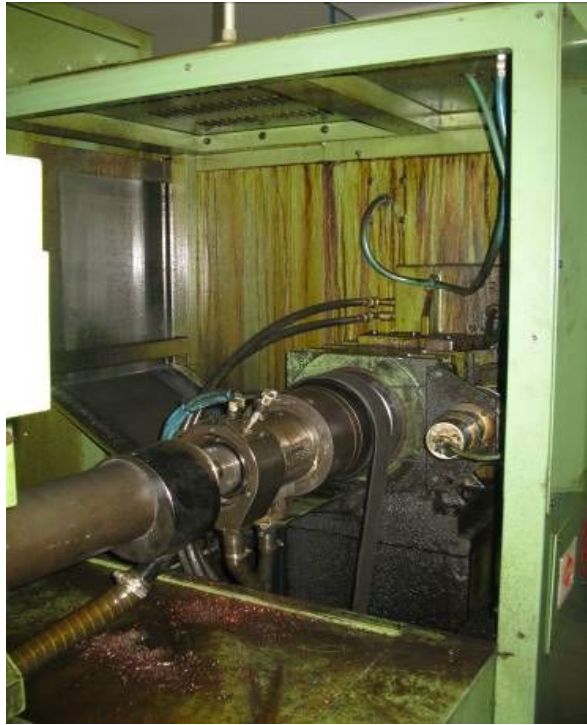
Lemezhengerítő gép henger meghajtásának teljes burkolata hiányzott
