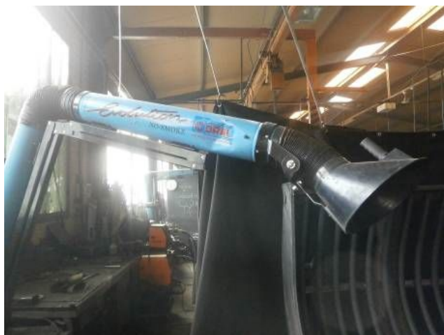
„Hagyományos” hegesztő munkahelyen és hegesztőrobotoknál kialakított elszívó rendszer
