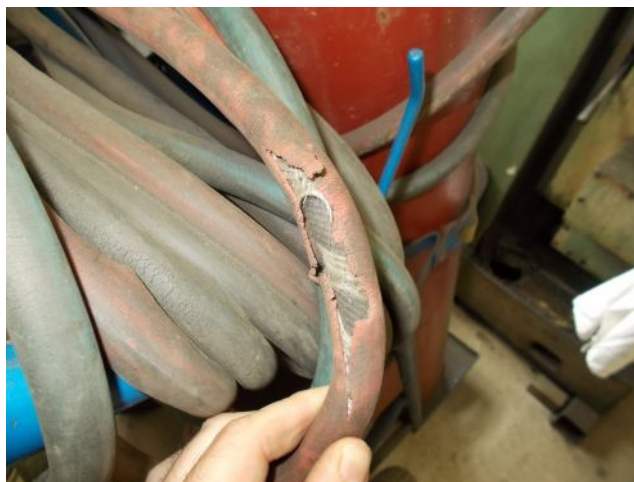
Repedezett, sérült hegesztő tömlők
