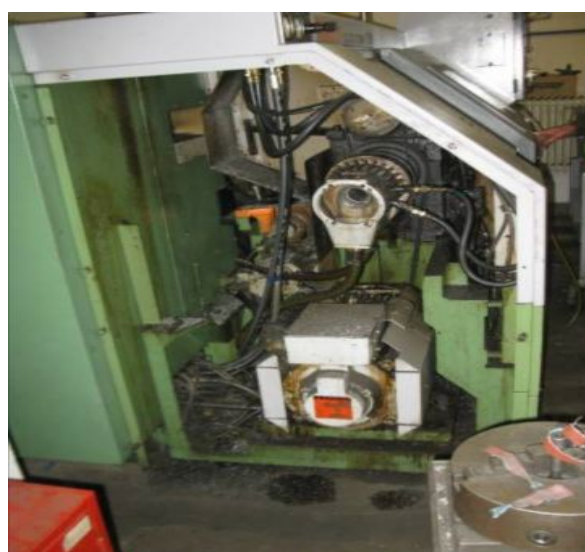
Leszerelt védőburkolatú CNC eszterga mozgó részei üzem közben megérinthetők
