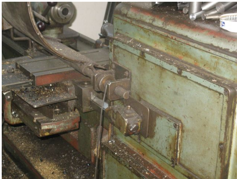
A csúcseszterga tokmány védőburkolata nem érintkezett a munkaeszköz leállítását lehetővé tevő (az áramellátást megszakító) kapcsolóval, ennek következtében a védőburkolat felnyitását követően a munkaeszköz tovább üzemeltethető volt
