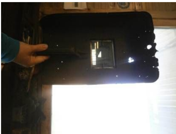
Átégett, hiányos védőüvegű hegesztőpajzs
