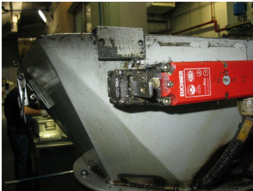
A forgácscentrifuga fedelének zárt állapotát érzékelő villamos kényszerkapcsolatot (reteszt) kiiktatták
