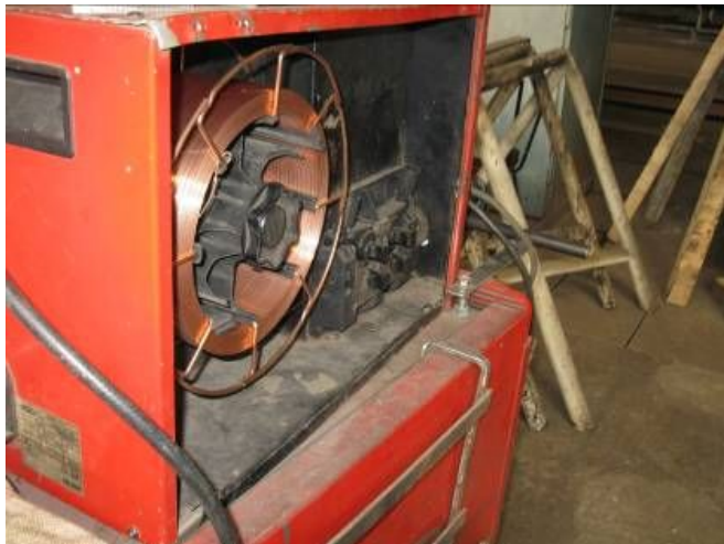
Hegesztő berendezések huzalelőtoló egységének hiányzó gyári burkolata
