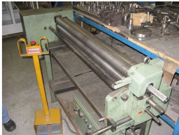
Hengerítő gép lábpedállal, vészleállítóval
