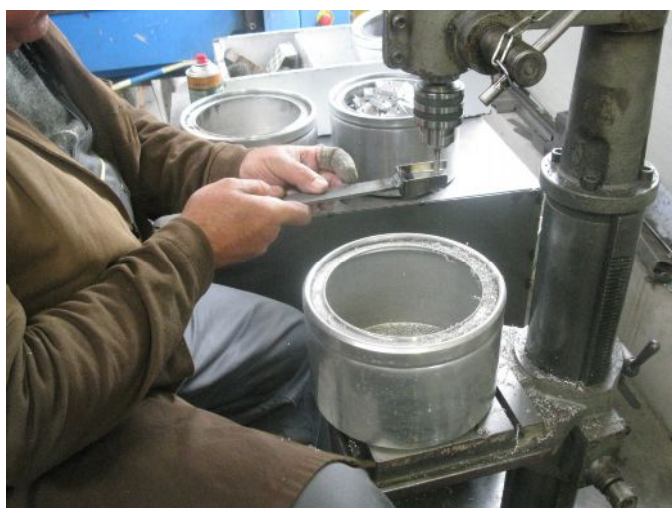
A kézben tartott munkadarab nincs kellően rögzítve, így az bármikor kivágódhat, sérülést okozva a munkavállalónak
