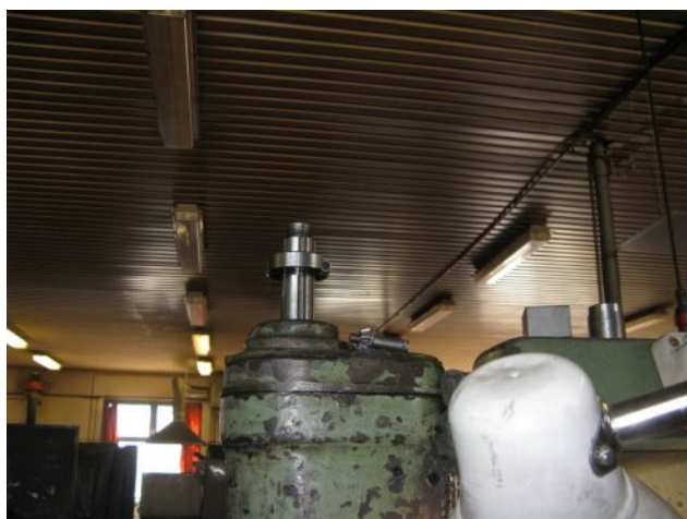
Esztergagép marótüskéjének védőburkolata hiányzott kb. 160 cm magasságban
