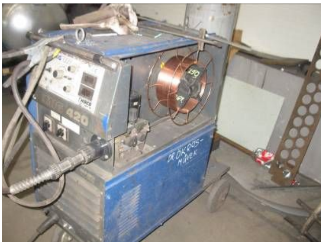
Hegesztő berendezések huzalelőtoló egységének hiányzó gyári burkolata
