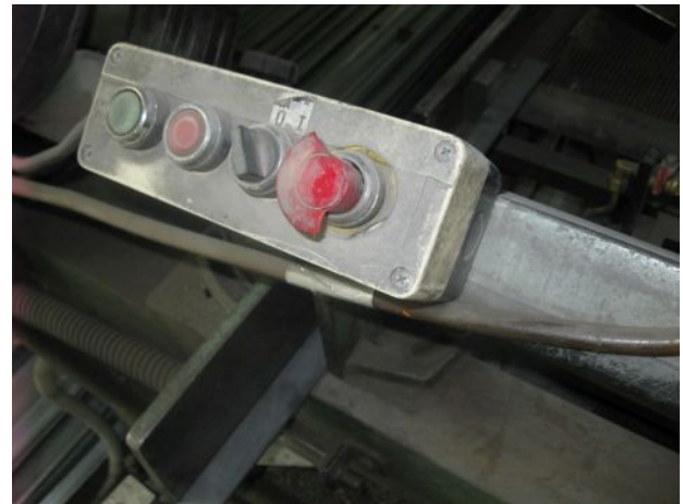
Szalagfűrész kezelőpanel törött vészleállító gombbal.
