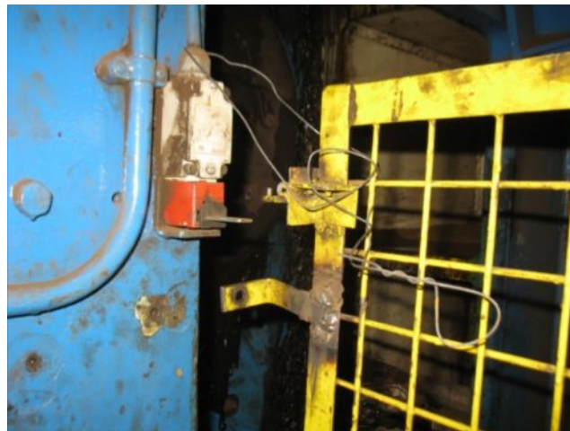
A darabológép veszélyes területét lehatároló védőburkolat reteszkapcsolójának ellendarabja a reteszkapcsolóba volt elhelyezve, ami miatt a gép nyitott védőburkolat mellett is üzemelt
