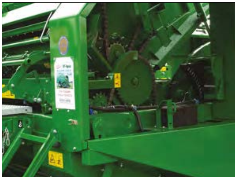
Egy görgős bálázó láncai, feltüntetett biztonsági jelölések – a FIOH jóvoltából
